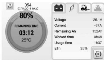
Fila cu informații despre starea de funcționare al acumulatorului
