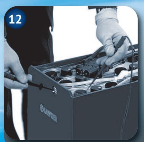
Izmeriti električnu otpornost kućišta
