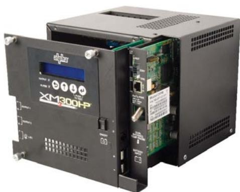
Fig. 3-1, Removendo o módulo inversor
