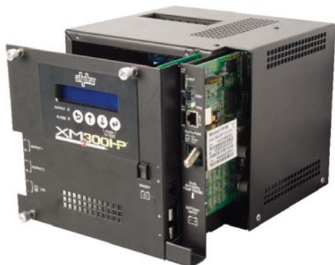
Fig. 3-1, Retiro del módulo inversor
