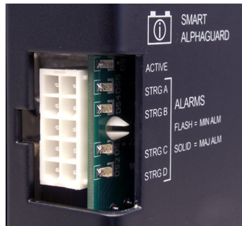
Fig. 1-12, Panel frontal del SAG
