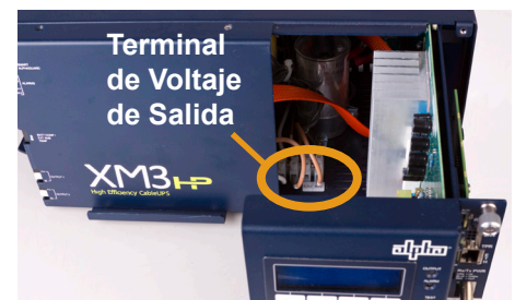
Fig. 2-13, Extracción del módulo inversor y ubicación de los terminales de voltaje de salida
